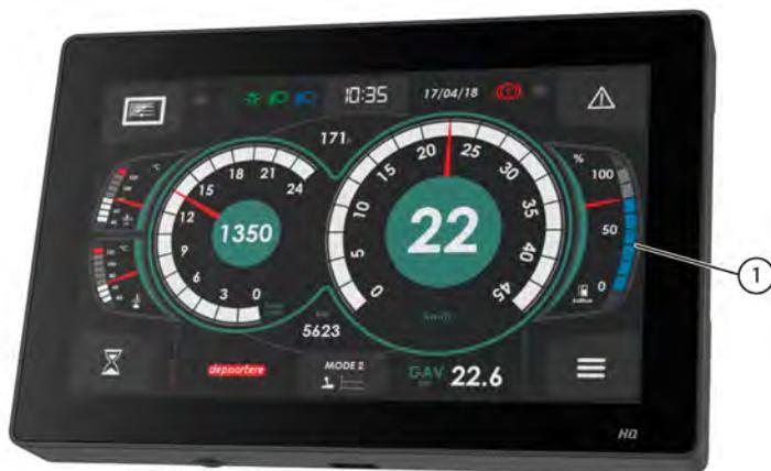
Fig. 128 Affichage du niveau AdBlue sur la fenêtre du mode route
