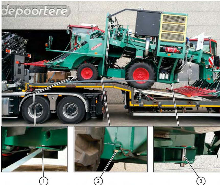
Fig. 47 Fixer la machine sur le camion
