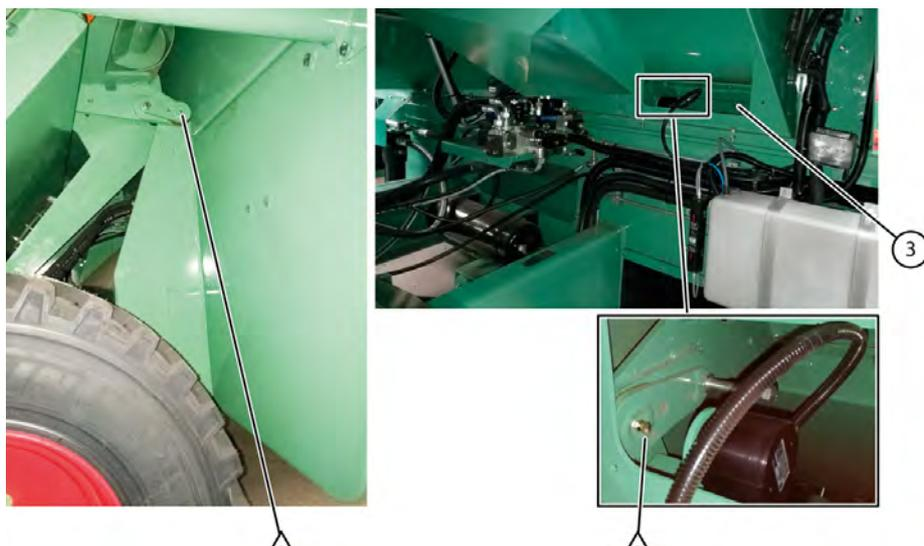
Fig. 141 Lubrifier les points charnières de l'arracheur
