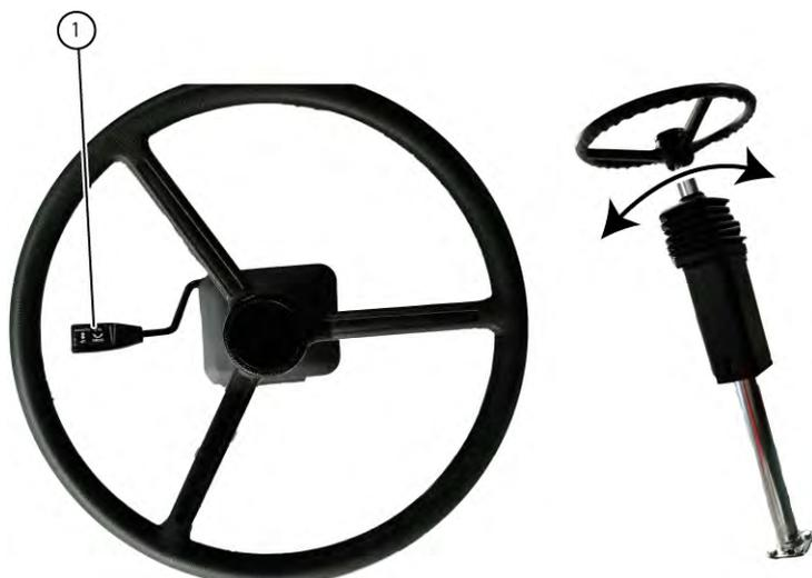
Fig. 83 Poignée de la colonne de direction
