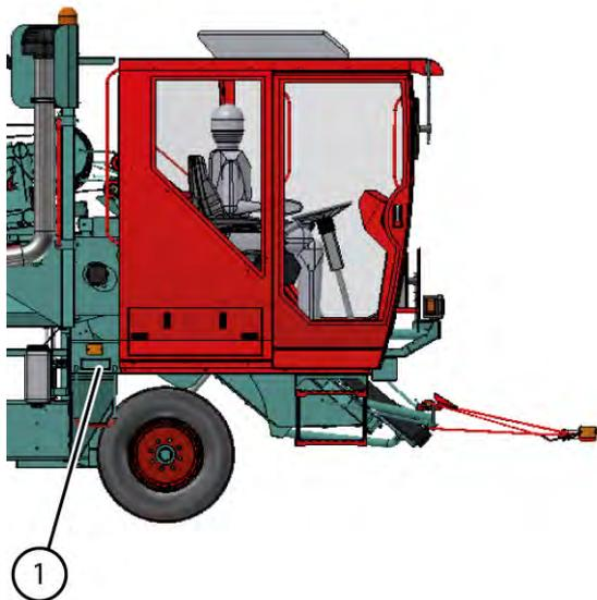
Fig. 1 Emplacement de l'indication du type de la machine
