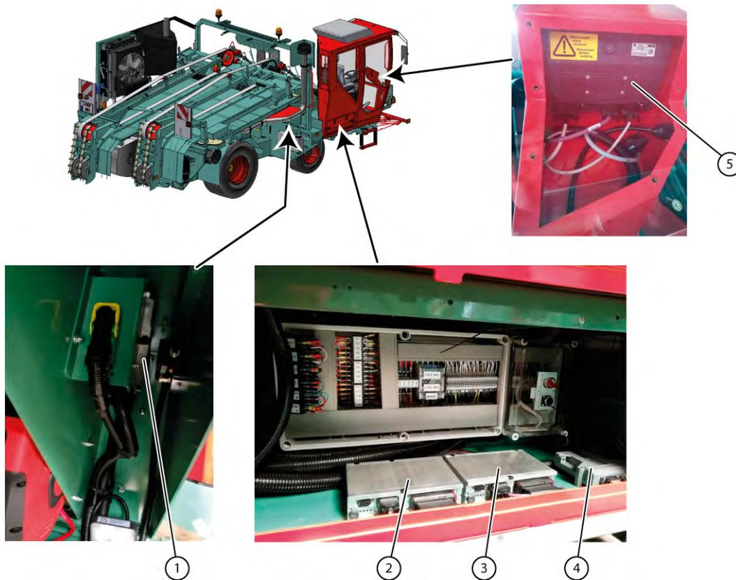
Fig. 28 Emplacement des contrôleurs
