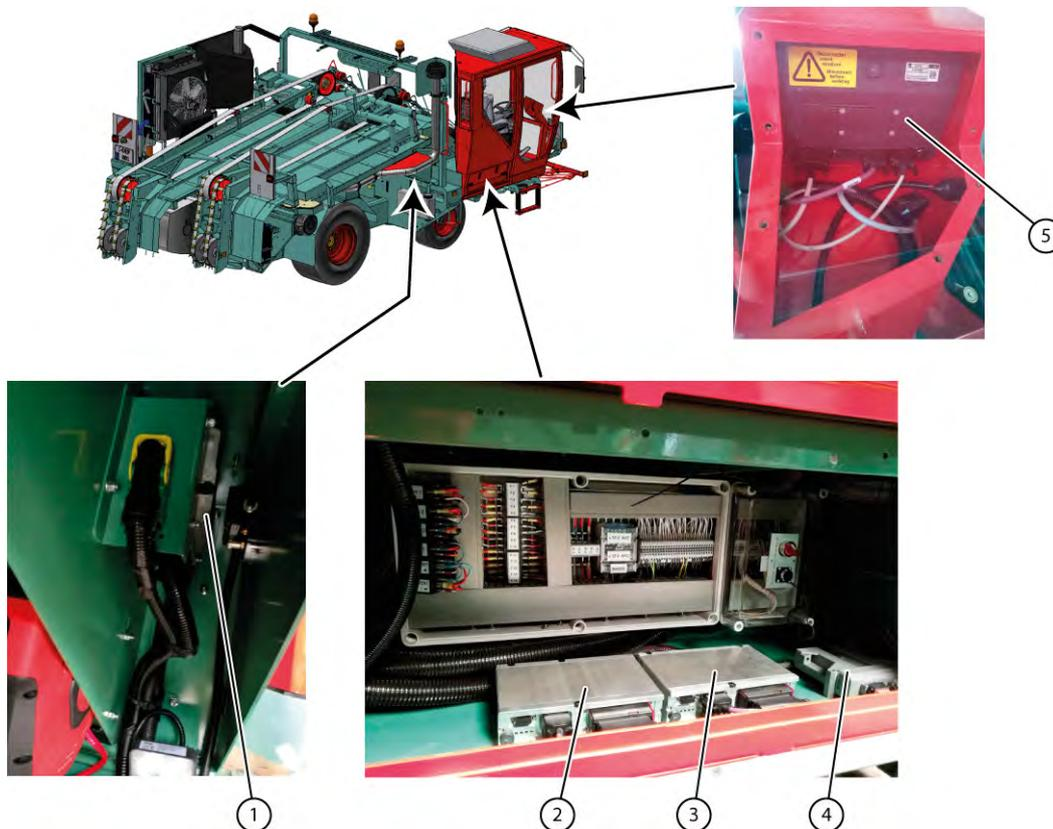
Fig. 166 Emplacement des contrôleurs
