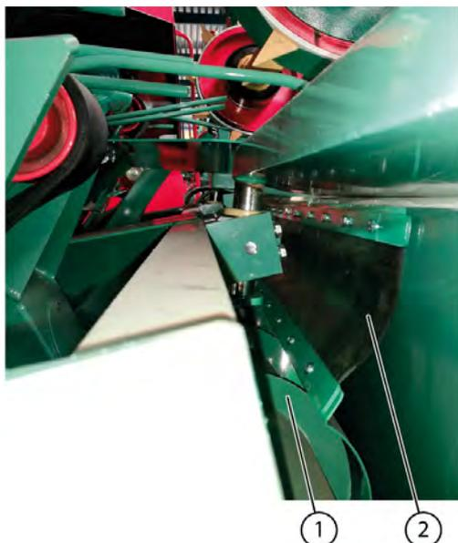
Fig. 139 Vérifier l'état du rabat en caoutchouc sur le vérin
