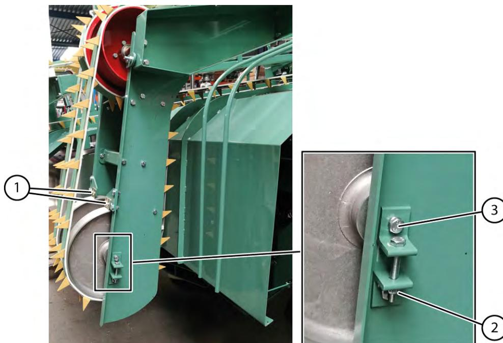
Fig. 93 Régler la tension des courroies de dépôt
