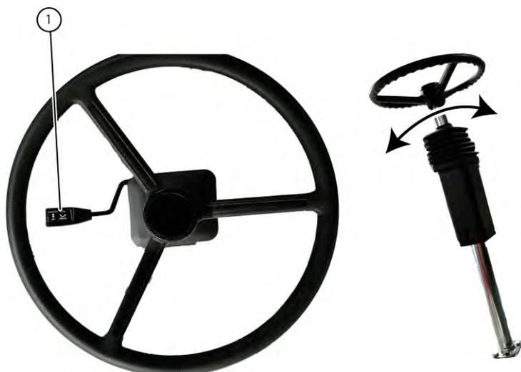
Fig. 82 Poignée de la colonne de direction
